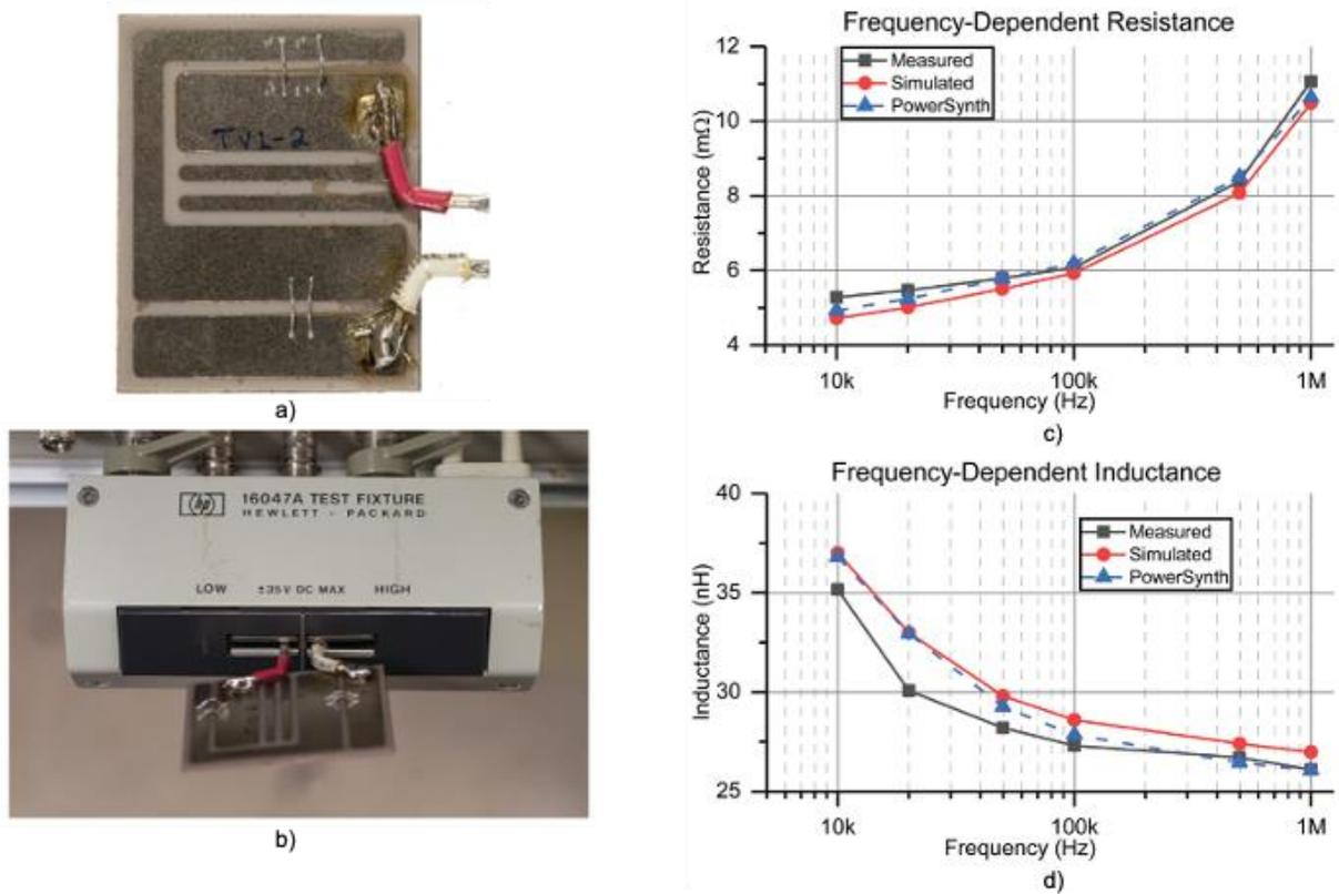
**Fig. 1.7 (a) Fabricated layout (b) Impedance analyzer (c) Resistance (d) Inductance**
